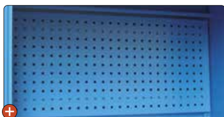
Panneau perforé pour support-outils Perforations carrées 10 x 10 au pas de 38 mm
