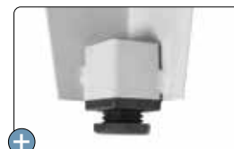
Vérin de réglage 30 x 30 mm, course de 18 mm
