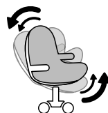
MÉCANISME ASYNCHRONE : Le dossier et l'assise s'adaptent de façon individuelle aux mouvements de la personne assise, permettant ainsi une meilleure position du corps.
